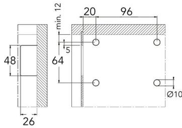
**Système de suspension type 807 XL pour armoires basses avec anti-décrochement**
