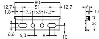
**Plaquette de fixation type 892.AC.Z2.80.26 pour support de panneau réglable supérieur**
