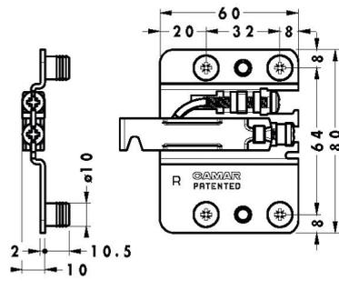
**Système de suspension type 807 pour armoires basses avec anti-décrochement**
