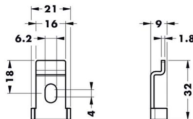
**Plaquette de fixation type 814.AC.Z1.16.35**
