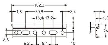
**Plaquette de fixation type 890.AC.Z1.01.00 pour support de panneau inférieur**
