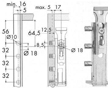
**Système de suspension type Traser 6 Rapid Fitting**
