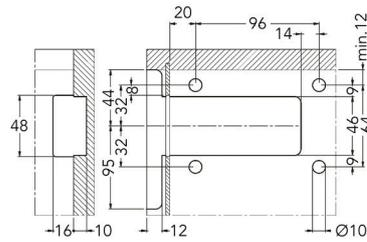
**Système de suspension à encastrer type 807 RV XL pour armoires basses avec anti-décrochement**
