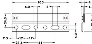
**Plaquette de fixation type 814.AC.Z1.01.00 pour support de panneau**
