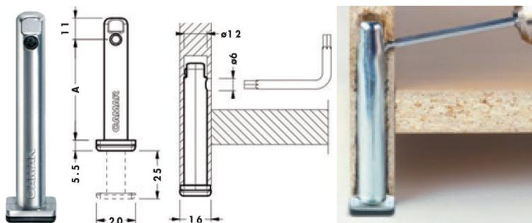
Vérin de réglage type 306 avec diamètre 12 mm
