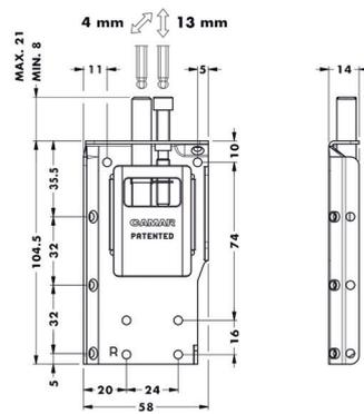
**Système de suspension type 822 avec anti-décrochement**
